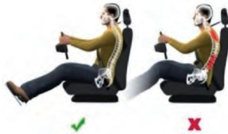
La distanza dal volante e dai pedali deve essere regolata in modo ottimale: le braccia devono essere estese in modo di poter appoggiare comodamente il palmo della mano sulla parte superiore del volante.
