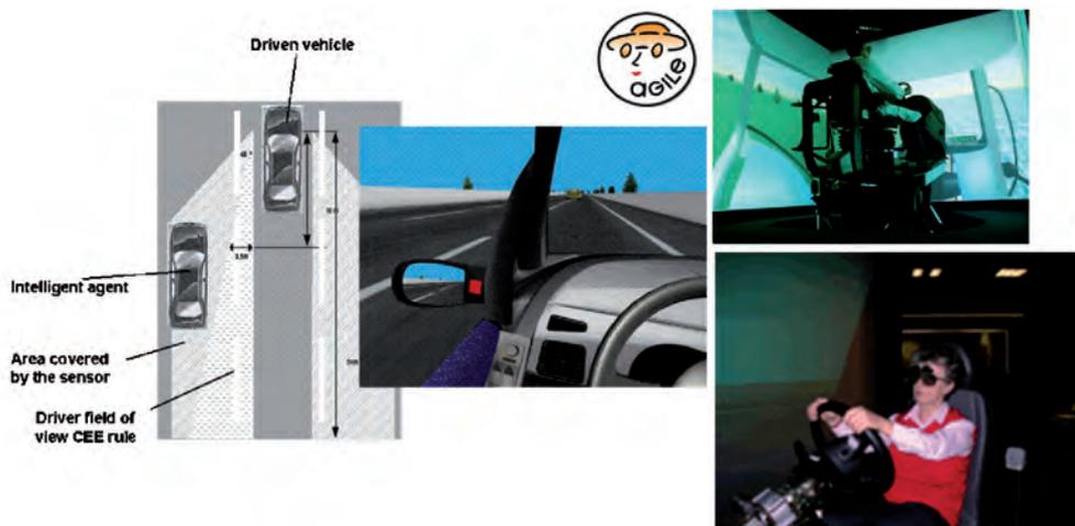
Fig. 9 - Studio sul monitoraggio della zona cieca nel simulatore di guida del CRF.
