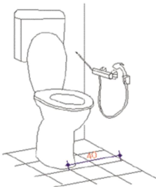
Se si utilizza una doccetta posizionata a lato del vaso e dotata di miscelatore termostatico esterno, la distanza dal muro al centro del vaso non deve essere inferiore ai 40 cm.
